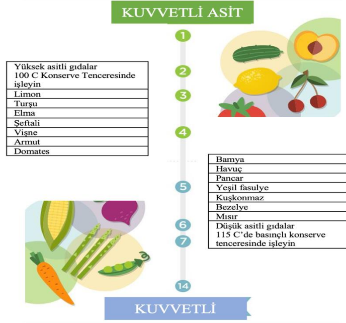
Şekil 26. pH seviyesini öğrenmek. Kaynak: Ball® Mason Jars & Home Canning, www.freshpreserving.com (100°C=212°F; 115,5 °C=240°F)
